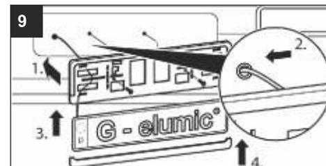
Befestigen Sie den Nummernschildhalter am Fahrzeug. Führen Sie das Kabel durch das Bohrloch und befestigen Sie das G-elumic® Schild.
