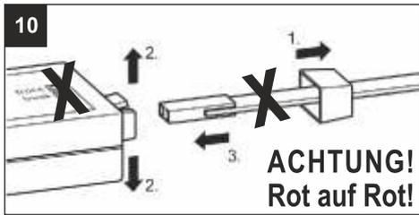
Ziehen Sie die Kappe vom freien Ende des Inverters ab. Stecken Sie die Kappe über das Kabel des Nummernschildes. Befestigen Sie den Stecker im Kontakt des Inverters.
