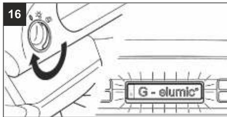
Vor Anbringen der Innenverkleidung prüfen Sie die korrekte Funktion des G-elumic® Nummernschildes.
